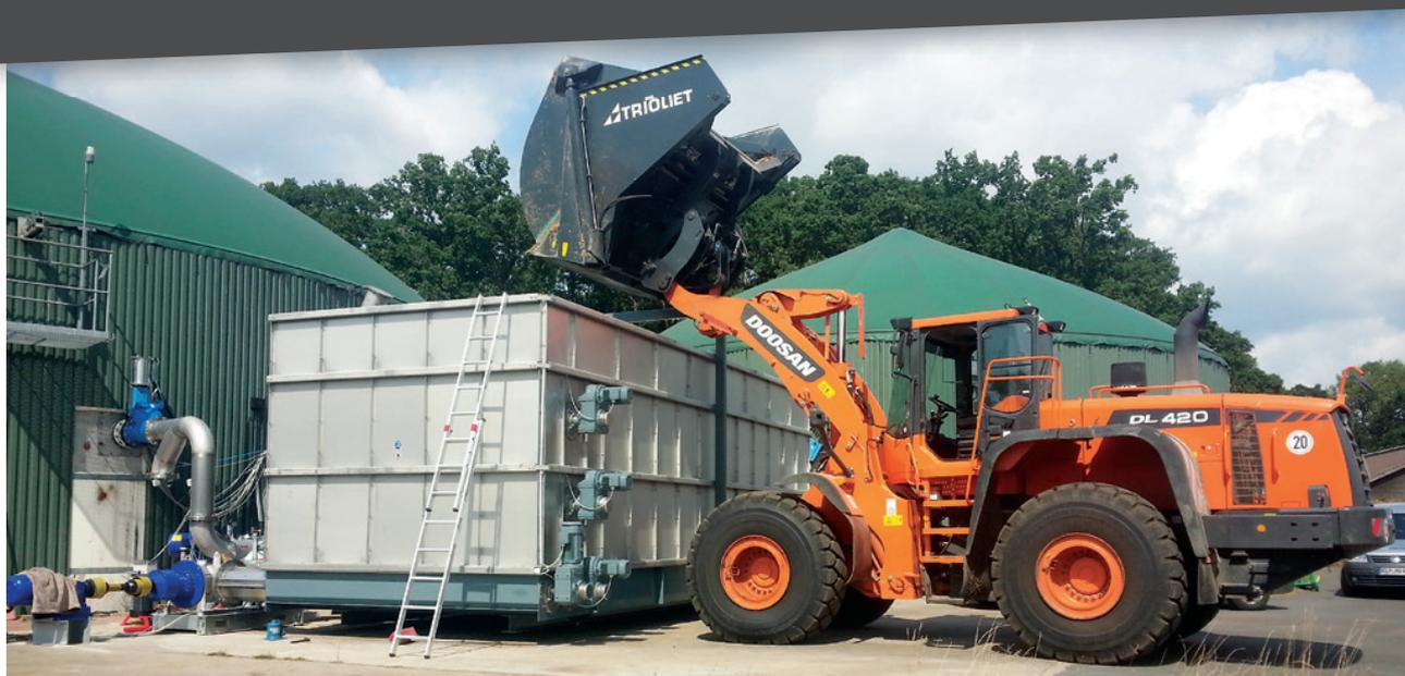
Der Feststoffeintrag wird mit Maissilage befüllt
